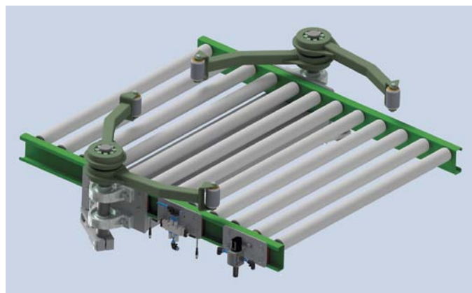
Blokada na przenośniku
