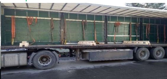
Poprawne znakowanie - zawieszka metalowa – oznaczenie elementu na palecie lub w paczce oraz przygotowanie belek do położenia konstrukcji na naczepie
