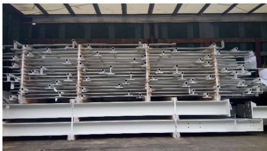
Poprawne pakowanie barierek – z przekładkami oraz spięte taśmami, przykład taśmowania
