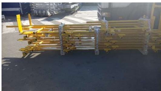
Poprawne znakowanie - zawieszka metalowa – oznaczenie elementu na palecie lub w paczce oraz przygotowanie belek do położenia konstrukcji na naczepie
