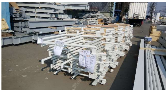
Poprawne pakowanie barierek – z przekładkami oraz spięte taśmami, przykład taśmowania
